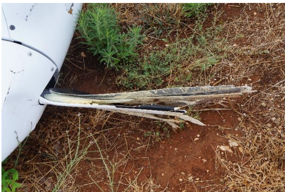
Slike 5. i 6. – Oštećenja propelera i trupa zrakoplova
