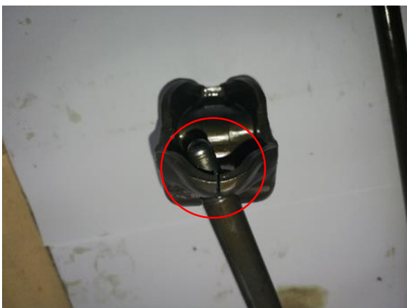
Slika 4 – Oštećena klackalica ispušnog ventila
