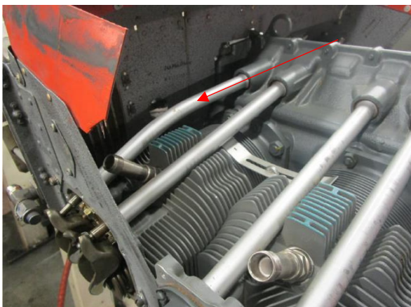
Slika 2 – Savijena šipka podizača usisnog ventila
