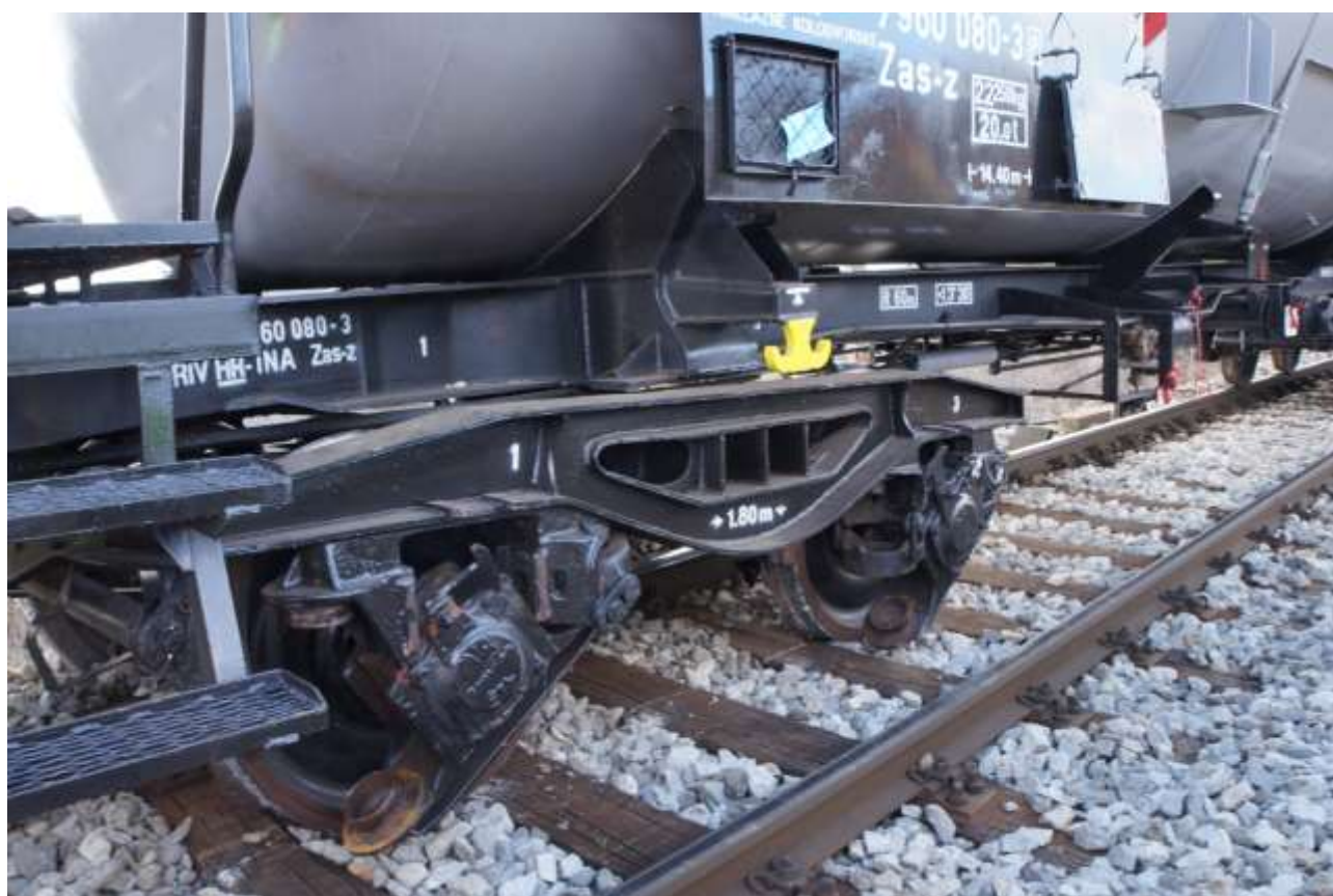
Slika 11. – Detalj iskliznulog postolja 14. vagona (izvor slike: AIN)
