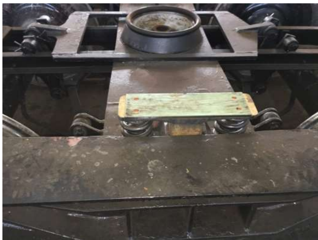
Slika 20 Okretna zdjela i bočni klizač vagona (Izvor AIN)
