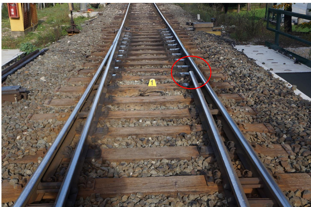
Slika 6. – Mjesto puknuća prijevodnice (izvor slike: AIN )
