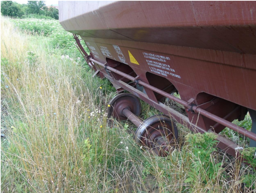
Slika 5. – Lijeva strana iskliznulog vagon (izvor slike: AIN )
