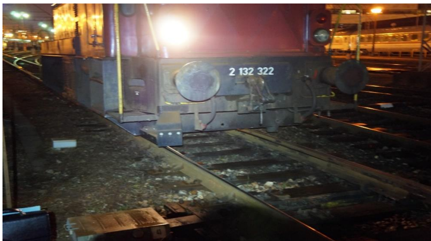
Slika 9. Iskliznula manevarska lokomotiva (Izvor slike: AIN)
