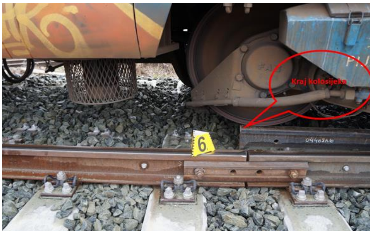
Slika 7. – Kraj kolosijeka u izgradnji (izvor slike: AIN)
