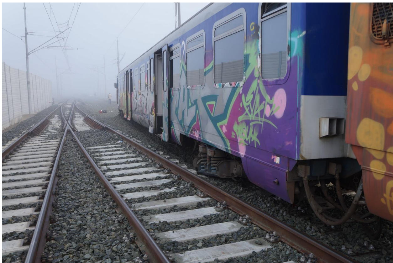
Slika 5. – Mjesto iskliznuća „B“ dijela sa oba okretna postolja (izvor slike: AIN)
