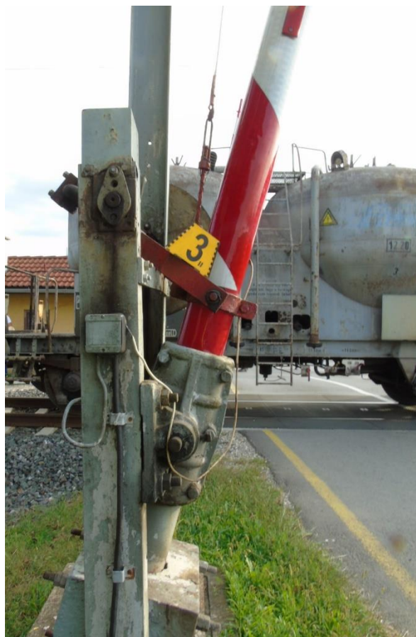
Slika 6. – Nespušteni branik na ŽCP-u „Pračno“ (Izvor slike: AIN)
