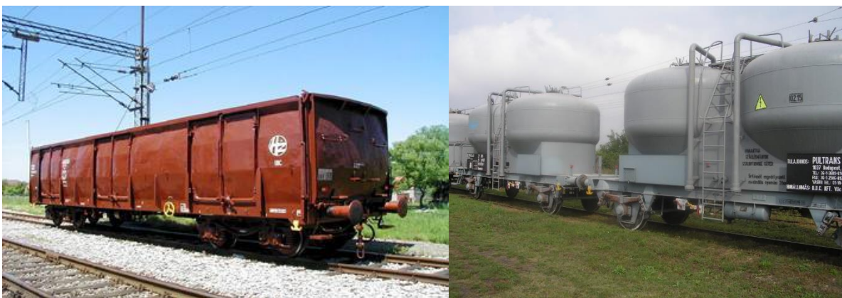
Slika 3. – Vagoni serije Eas i Ucmms (Izvor slike: www.hzcargo.hr i www.pultrans.hu )
