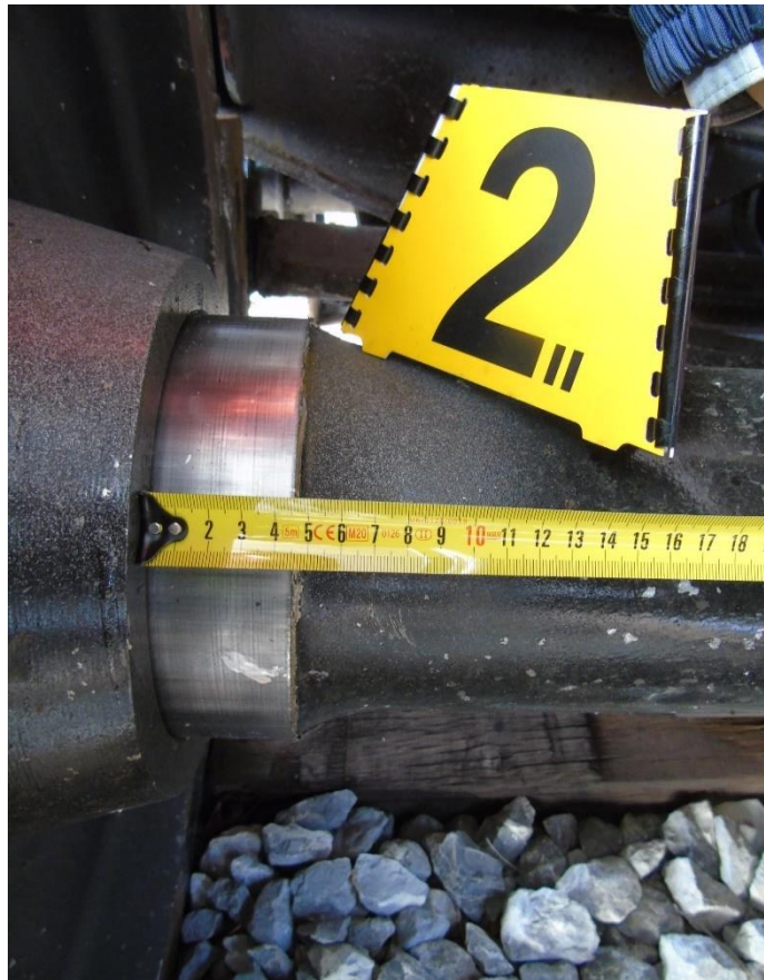
Slika 11. – Posmak po glavčini osovine prednjeg desnog kotača vagona br. 31 78 7850 041-0 (izvor slike: AIN)
