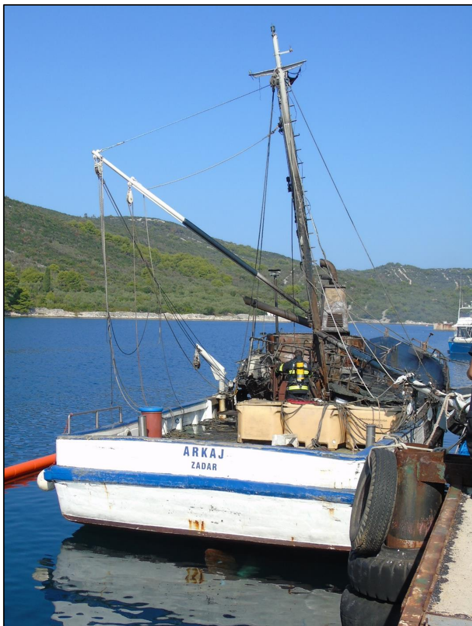
Slika 3. Brod „Arkaj“ na vezu nakon požara, gledan s krmene strane (izvor: AIN)
