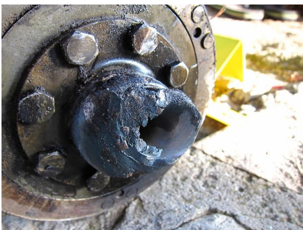
Slika 16 – Mjesto puknuća ulaznog vratila
