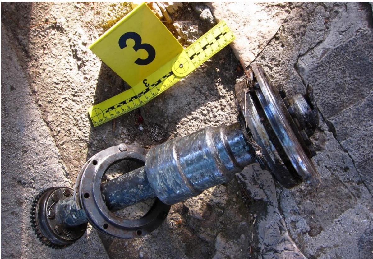
Slika 15 – Pogonsko vratilo (Drive shaft)
