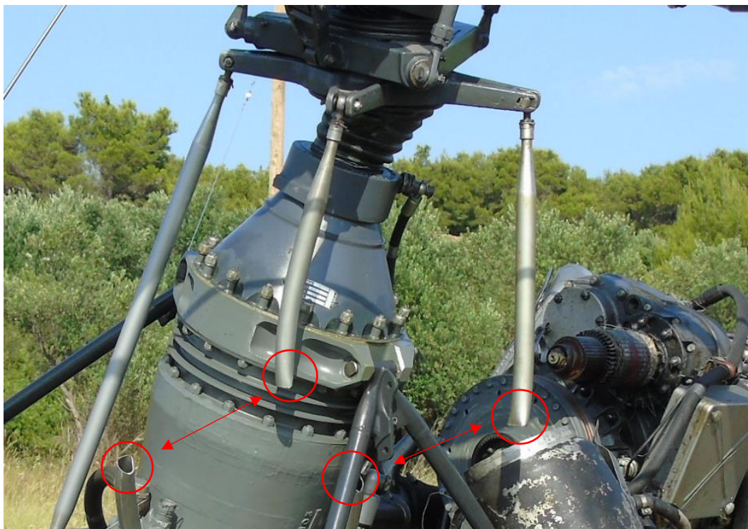
Slika 19 – Mjesta puknuća dviju poluga za kontrolu koraka krakova glavnog rotora
