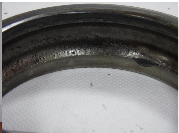
Slika 33 - Vanjska staza unutarnjeg ležaja
