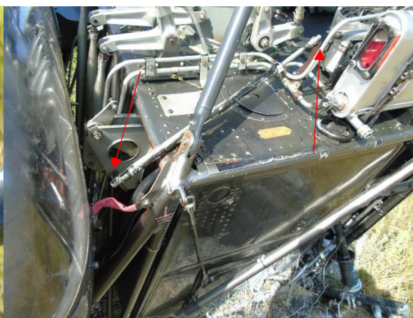
Slika 21 – Poluga kočnice glavnog rotora
