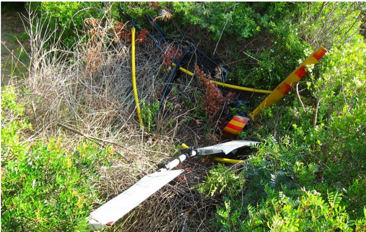
Slika 6 – Dio otkinute repne konstrukcije sa pripadajućim dijelovima
