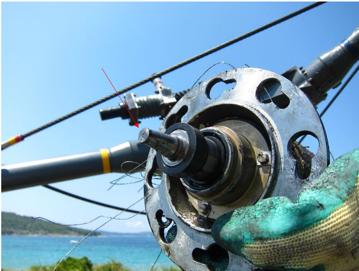
Slika 24 – Puknuta osovina starter-generatora
