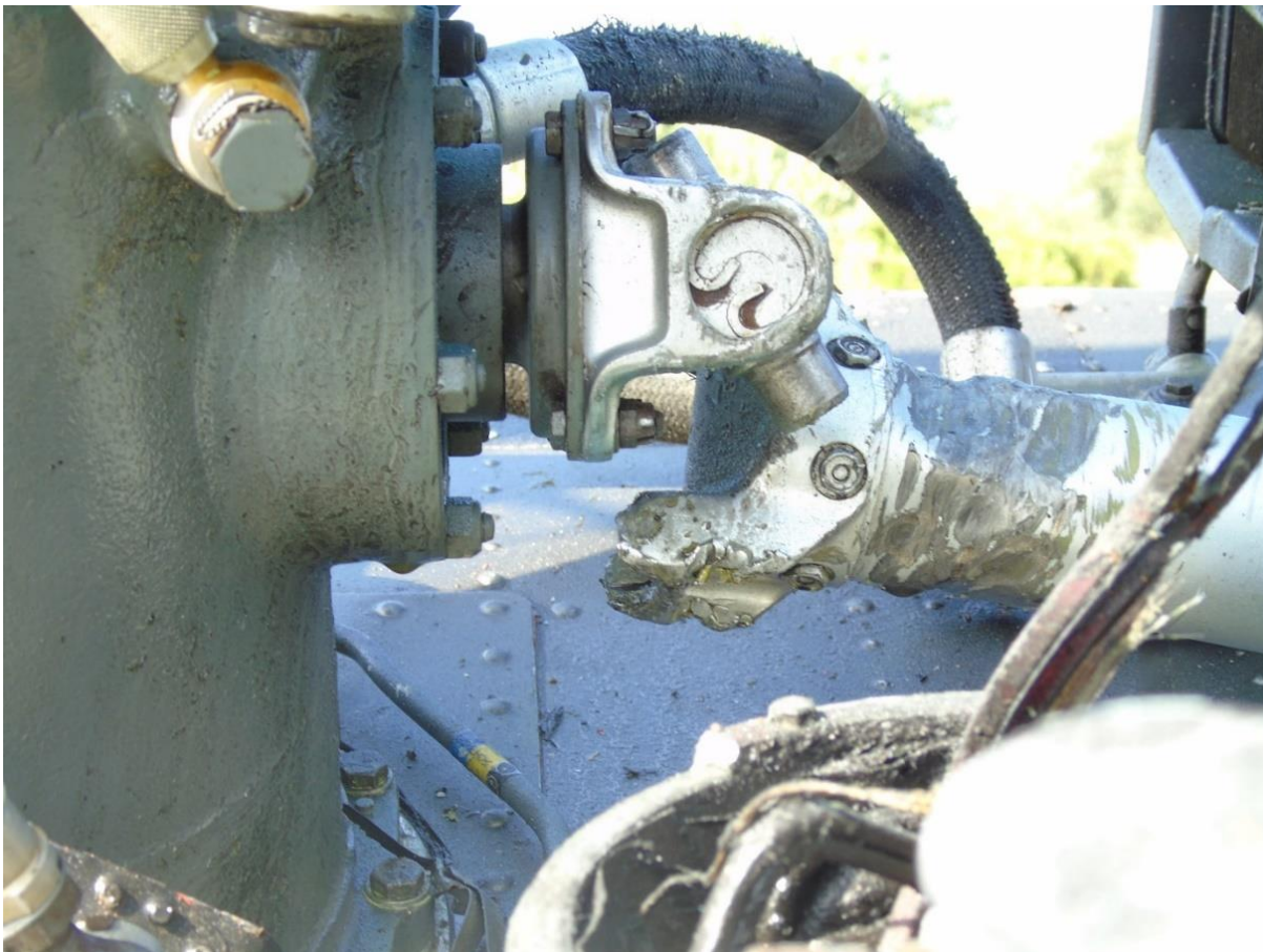
Slika 18 – Kardanski zglobovi izlaznog vratila (Cardan shaft drive assy) na mjestu puknuća
