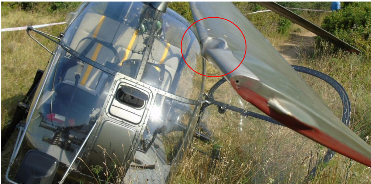
Slika 10 – Oštećenje kraka br. 1 glavnog rotora označeno crvenom bojom
