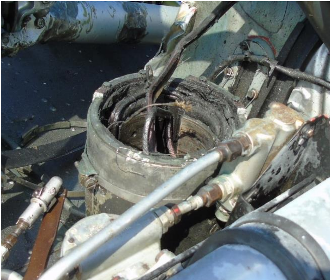
Slika 23 – Kućište statora i stator starter-generatora
