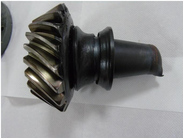
Slika 30 – Ulazno vratilo sa zupčanikom
