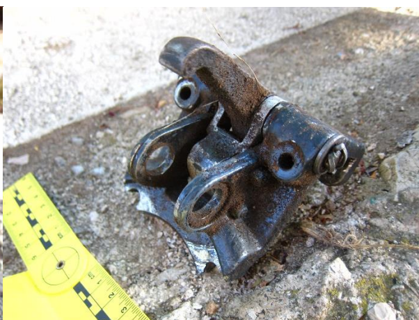
Slika 17 – Mehanizam kočionih kliješta
