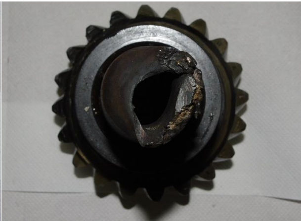
Slika 31 – Mjesto puknuća ulaznog vratila
