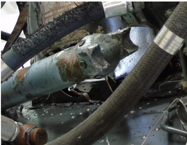
Slika 34 – Puknut kardanski zglob kardanskog vratila Slika 35 - Kvačilo
