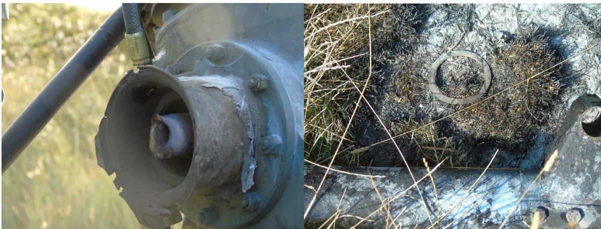
Slika 25 – Nastali otvor na glavnom reduktoru
