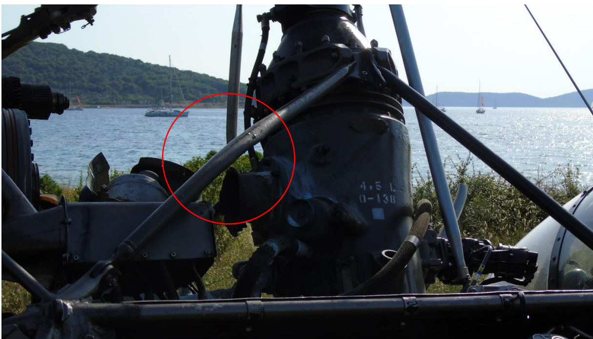
Slika 9 – Savijen nosač glavnog reduktora
