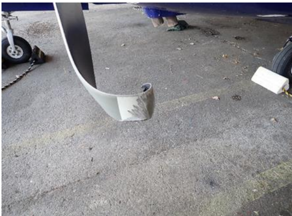
Slika 1 – Oštećenje vrha kraka elise
