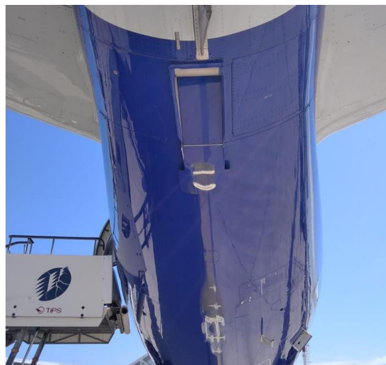
Slika 2 – Oštećenje oplata i vrata APU-a
