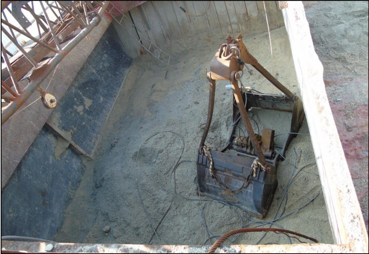
Slika 2. Prikaz količine tereta ukrcanog u brodsko skladište prije pomorske nesreće (pogled s pramca prema krmi) (izvor: AIN, 14. listopada 2022.)
