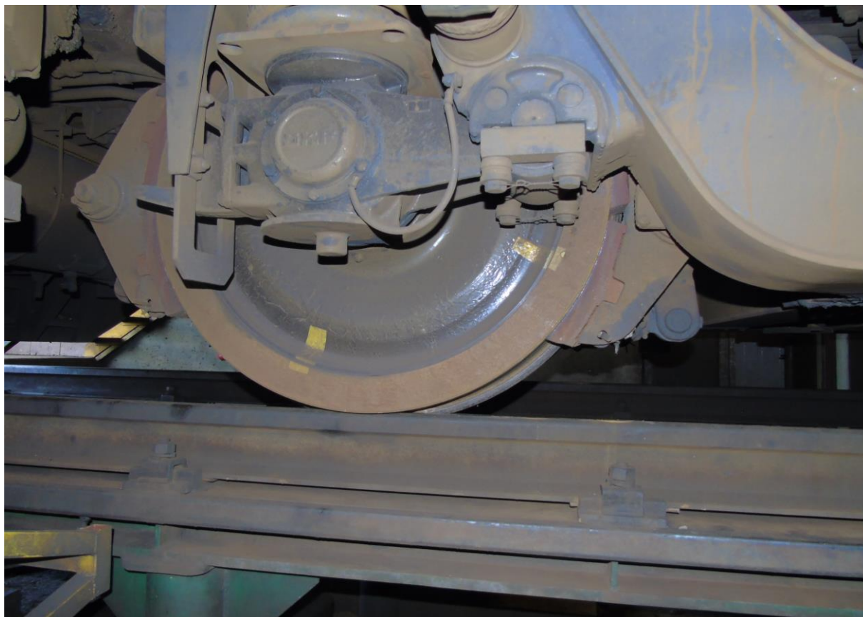
Slika 8. – Kočione papuče prve osovine na koje djeluje ručna kočnica lijeva strana (Izvor slike: AIN)
