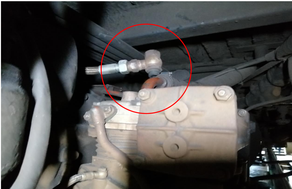
Slika 7. – Izbijeni priključak crijeva zraka na glavi kompresora (Izvor slike: AIN)
