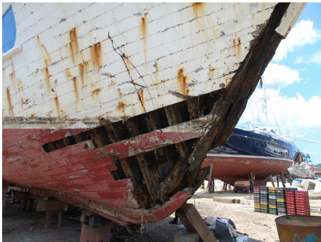
Slika 2. Ribarski brod „Val Dva“ nakon pomorske nesreće – oštećenja pramčanog dijela broda (izvor: AIN)
