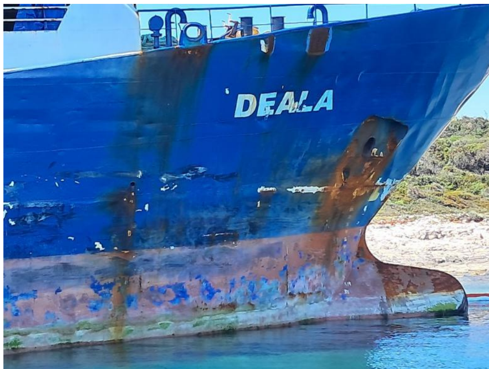
Slika 2. Teretni brod „Deala“ nakon pomorske nesreće; bez desnog sidrenog lanca (izvor: AIN)
