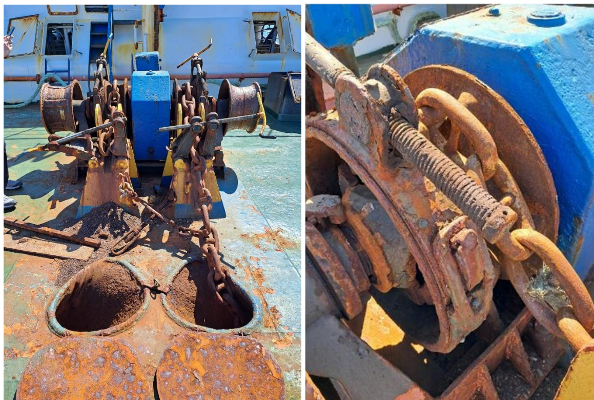
Slika 5. Desno i lijevo sidreno vitlo i kočnica na desnom sidrenom vitlu (izvor: AIN)
