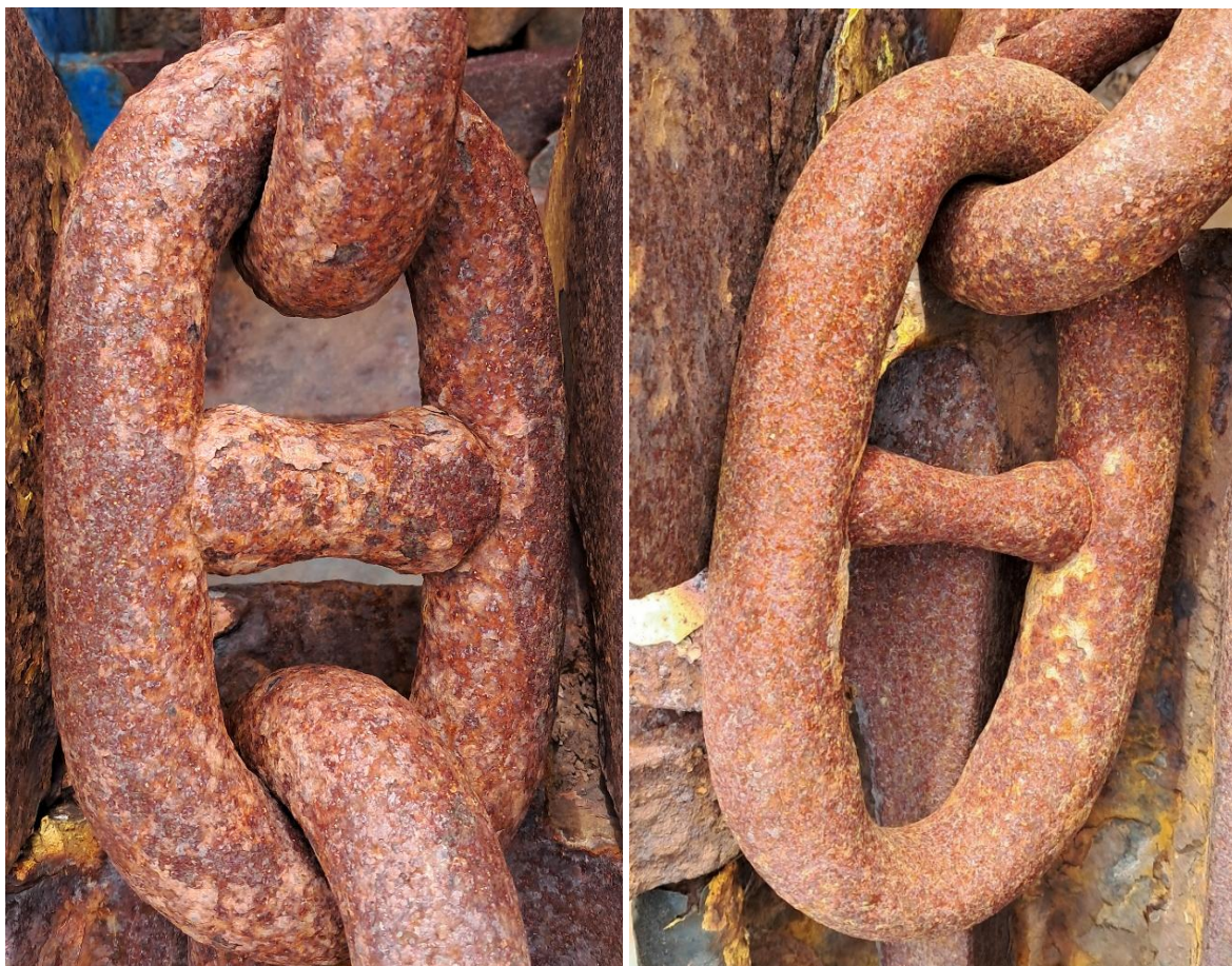
Slika 3: Usporedba karika sa lijevog i desnog sidrenog lanca (izvor: AIN)
