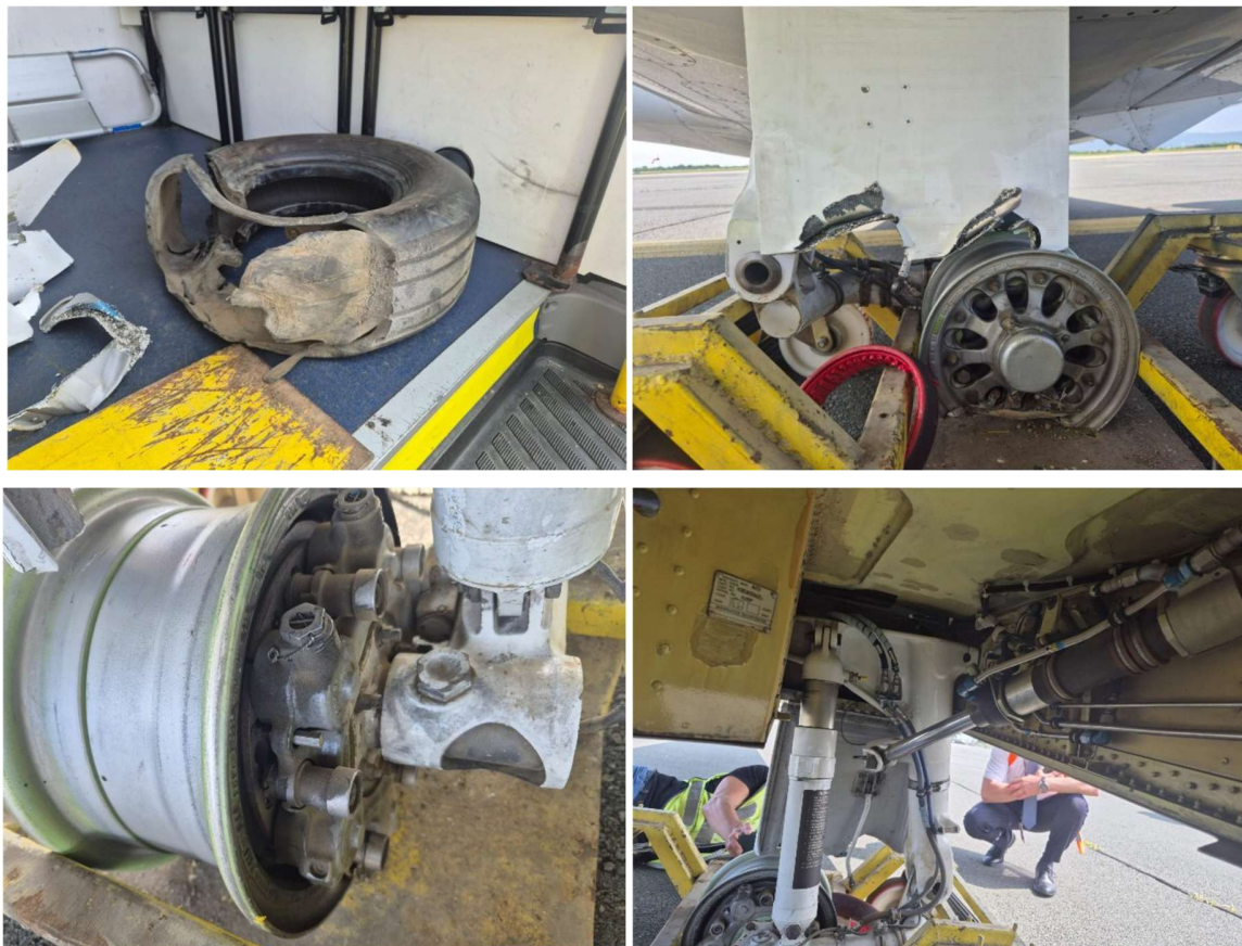
Slika 7 - guma, naplatak, kočnica i ostale komponente lijevog stajnog trapa
