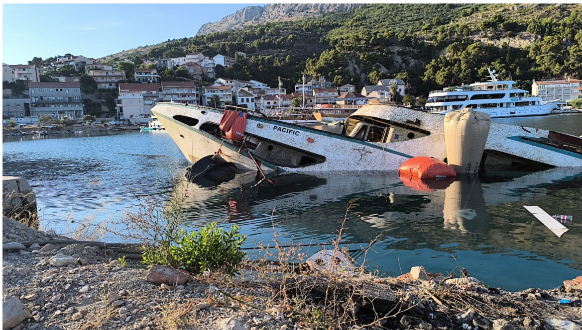
Slika 2. Putnički brod „Pacific“, tijekom procesa podizanja plovila na površinu mora (izvor: AIN)
