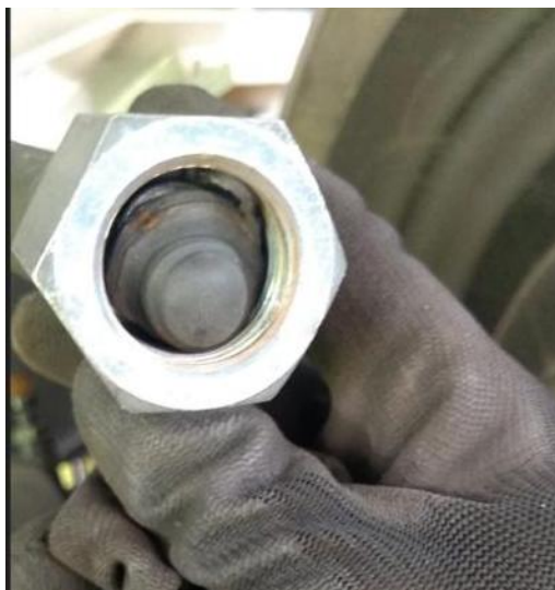
Slika 26. Primjer moguće zaostale gumene zaštite (Izvor slike: ATIR Rail)
