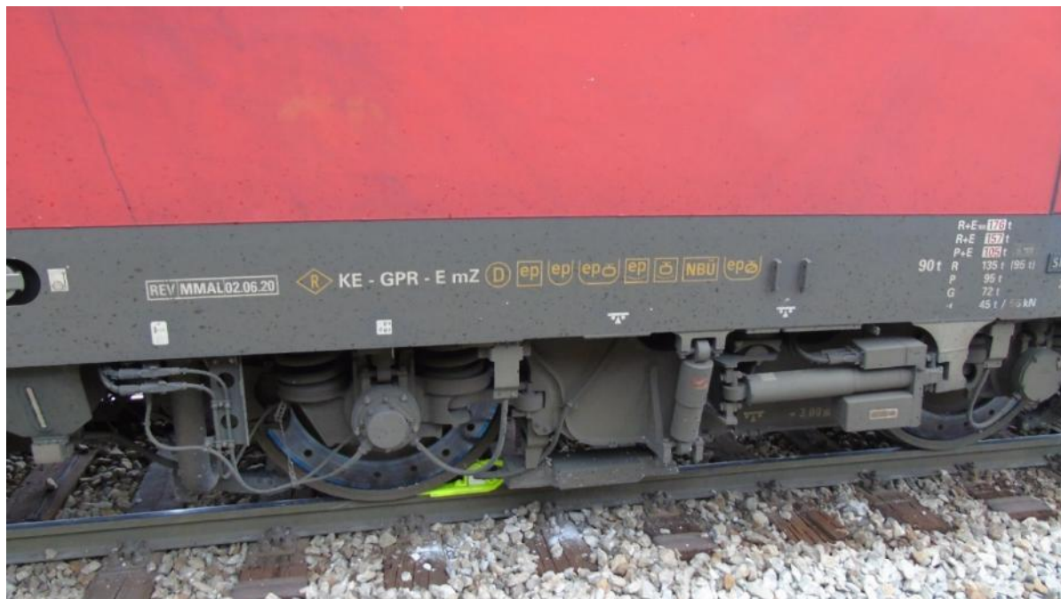
Slika 13. Kočioni disk na zaprežnoj lokomotivi broj 91 81 1293 080-8 (Izvor slike: AIN)
