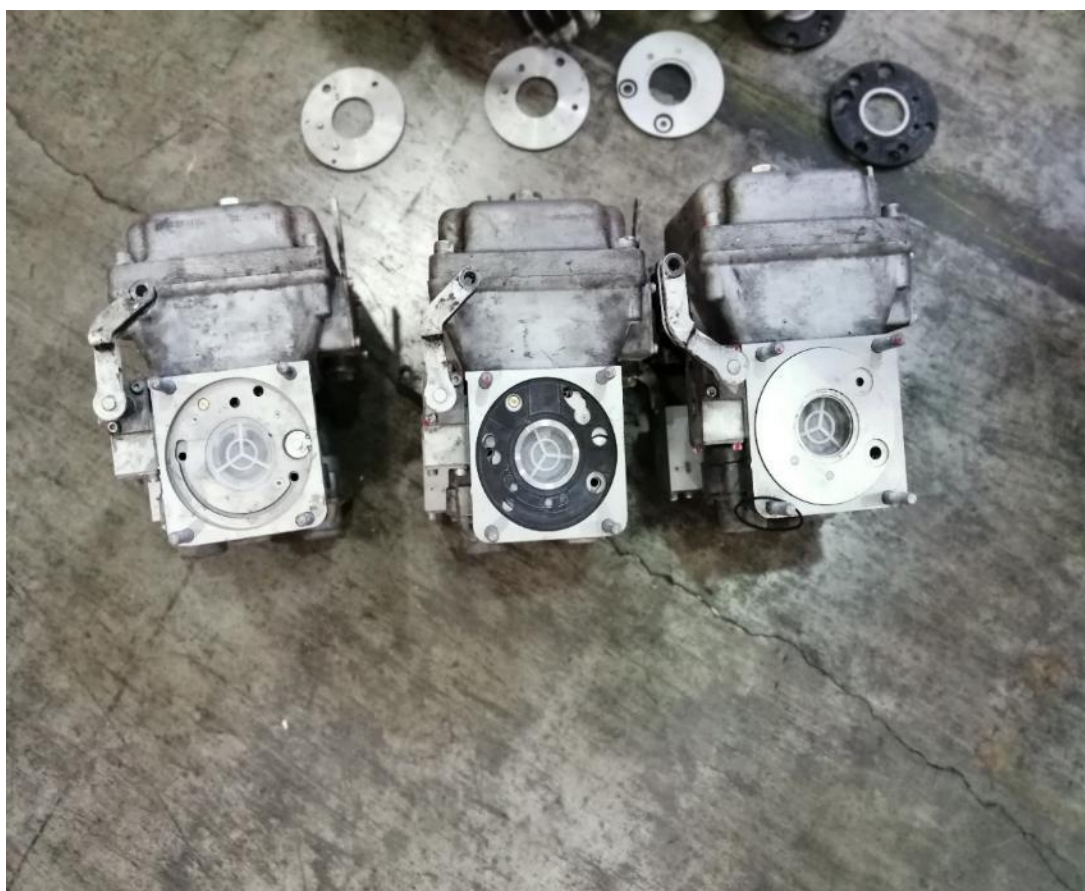
Slika 22. Rasporednici izuzeti s vagona serije Tangpps, proizvođač Wabtec (Izvor slike: AIN)
