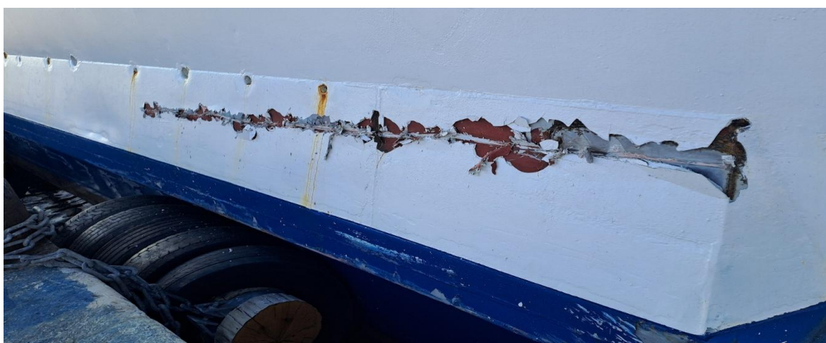
Slika 2. Dio oštećenja oplata trajekta „Petar Hektorović“
